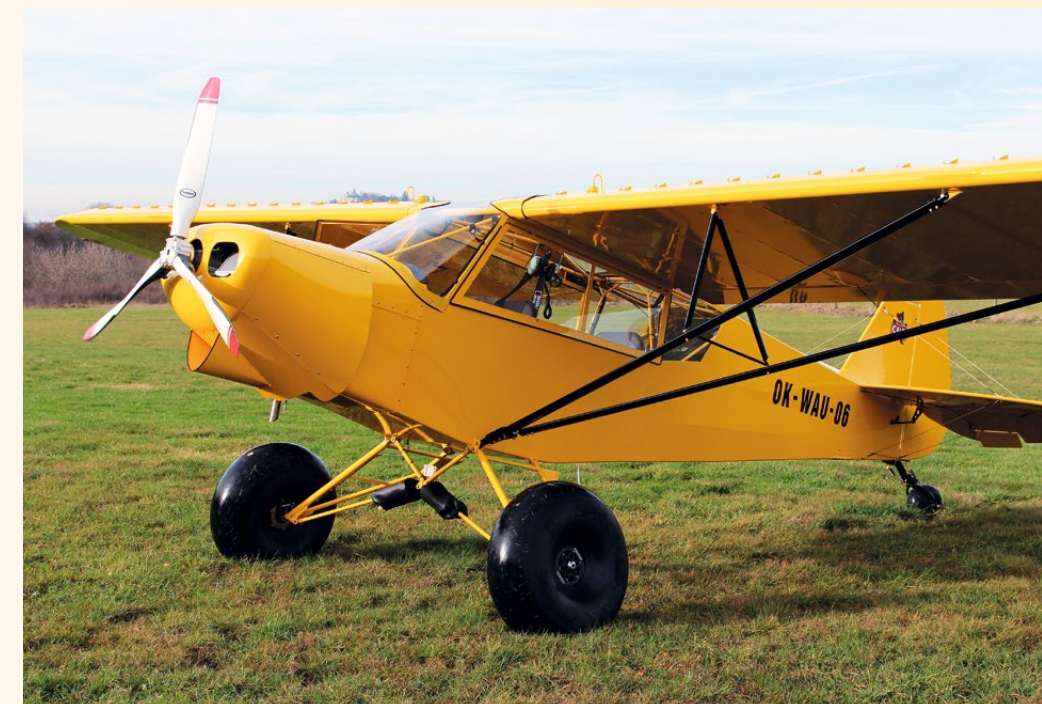
• Terénní pneumatiky a ostruha do terénu umožňují přistávat na širokou škálu povrchů.
